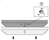
Режим тестирования управления освещением заканчивается автоматически через прим. 5 мин или кратковременным нажатием (< 1 c) кнопки (5.c  $\oplus$ ).
