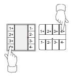
Ручной передатчик: короткое нажатие (< 1 с) правой кнопки ∨ (Рис. 8.е) Настенный передатчик: короткое нажатие кнопки 4- (Рис. 8.f)
