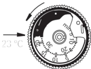
4. De este modo ajustará el anillo de ajuste azul al límite inferior de temperatura (aquí 8 °C): Introduzca en el orificio del anillo azul un objeto puntiagudo (p. ej. bolígrafo). Gire el anillo azul en el sentido de las agujas del reloj hasta llegar a 8 °C.
