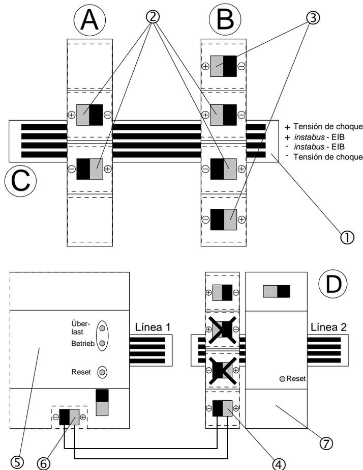
**Empalmador de 2 secciones** Fig. (A)
