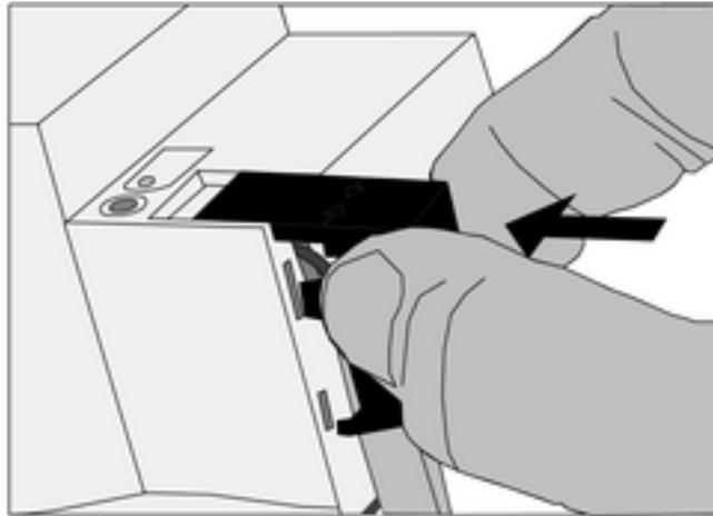
Figura 4: Applicazione della calotta di copertura
