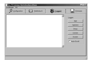
Mit der Funktion "Loggen" werden Aktivitäten der Inbetriebnahmesoftware und des TK-Gateways protokolliert. Das Loggen hilft, eventuelle Fehler bei der Kommunikation des TK-Gateways mit dem Gira Türkommunikations-Bus zu finden.
