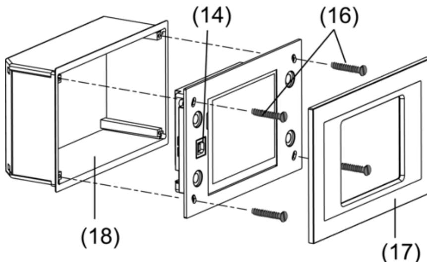
Imagen 5: Montaje en carcasa
