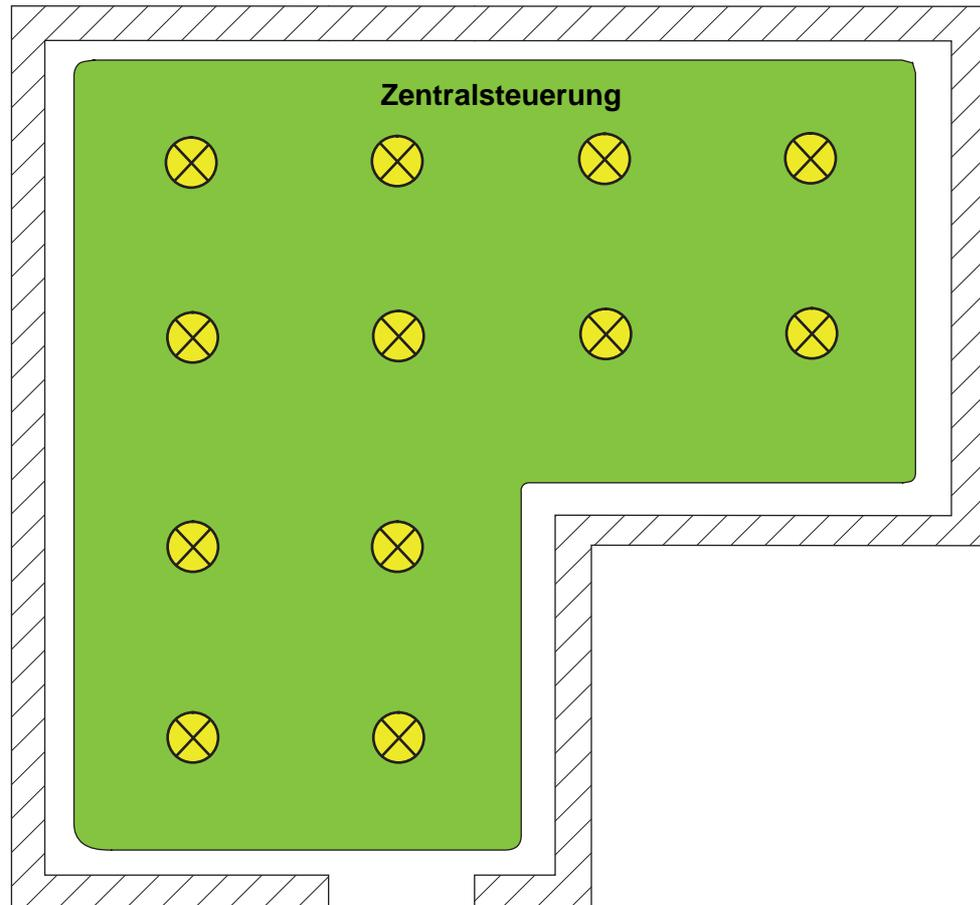
Bild 10: Beispiel einer Zentralsteuerung (Broadcast) - Nur eine Gruppe
