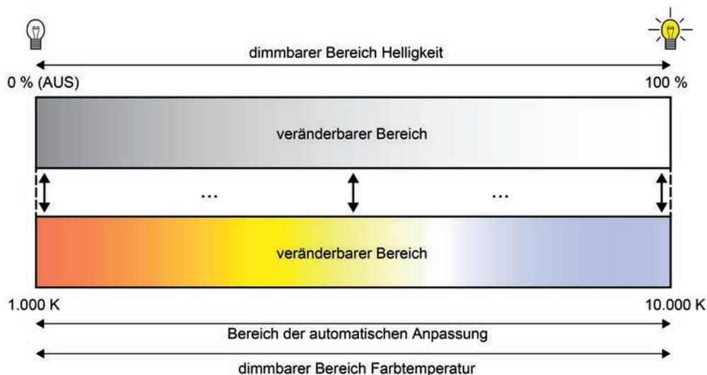
Bild 37: Automatische Anpassung der Farbtemperatur an die eingestellte Helligkeit
