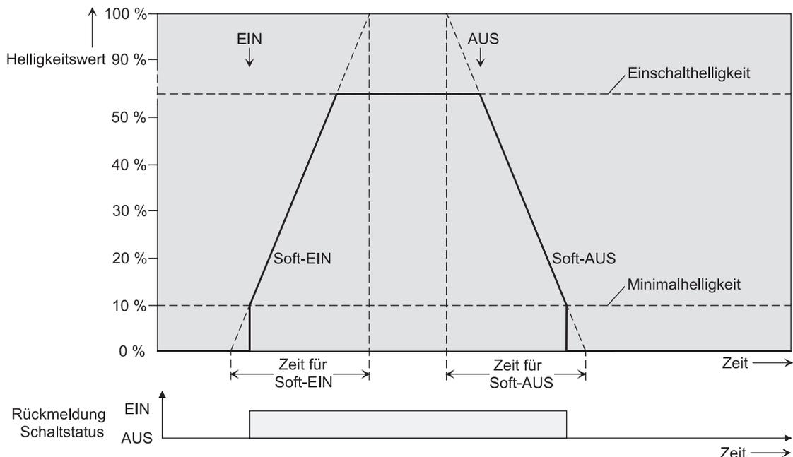
Bild 42: Dimmverhalten der Soft-EIN/AUS-Funktionen als Beispiel mit Minimalhelligkeit > 0%
