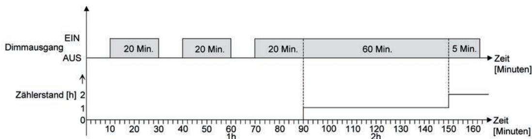
Bild 52: Funktionsweise des Betriebsstundenzählers (am Beispiel eines Vorwärtzählers)
