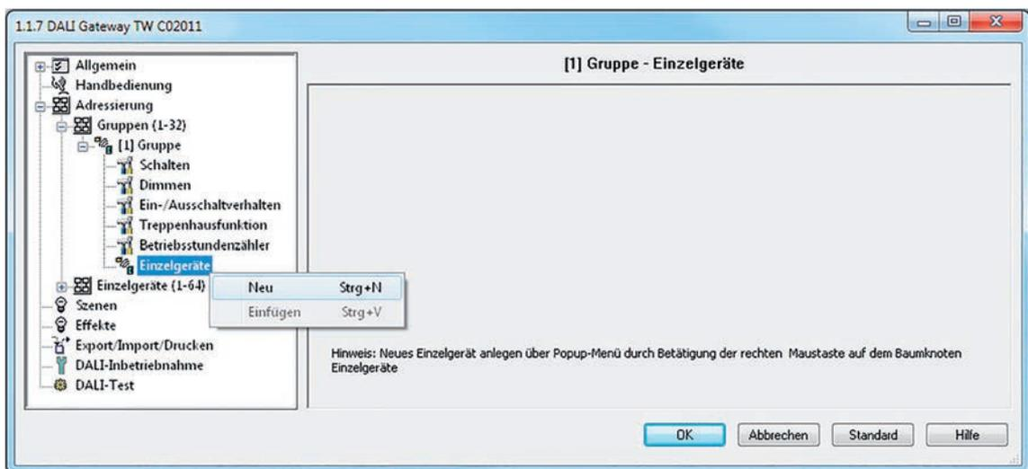
Bild 75: Zuordnen eines EVG zu einer Gruppe - Offline-Inbetriebnahme
