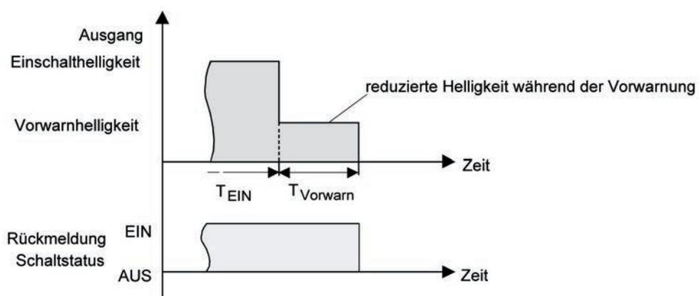
Bild 47: Die Vorwarnfunktion der Treppenhausfunktion ohne Soft-AUS-Funktion
