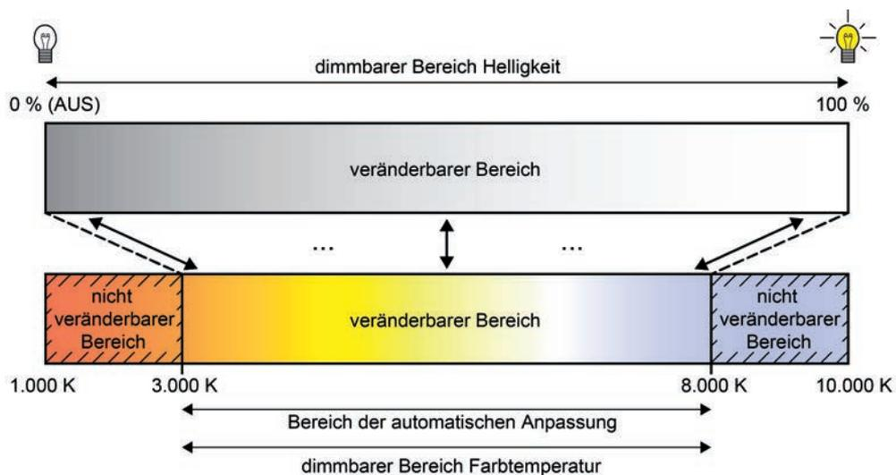
Bild 39: Automatische Anpassung der Farbtemperatur an die eingestellte Helligkeit
