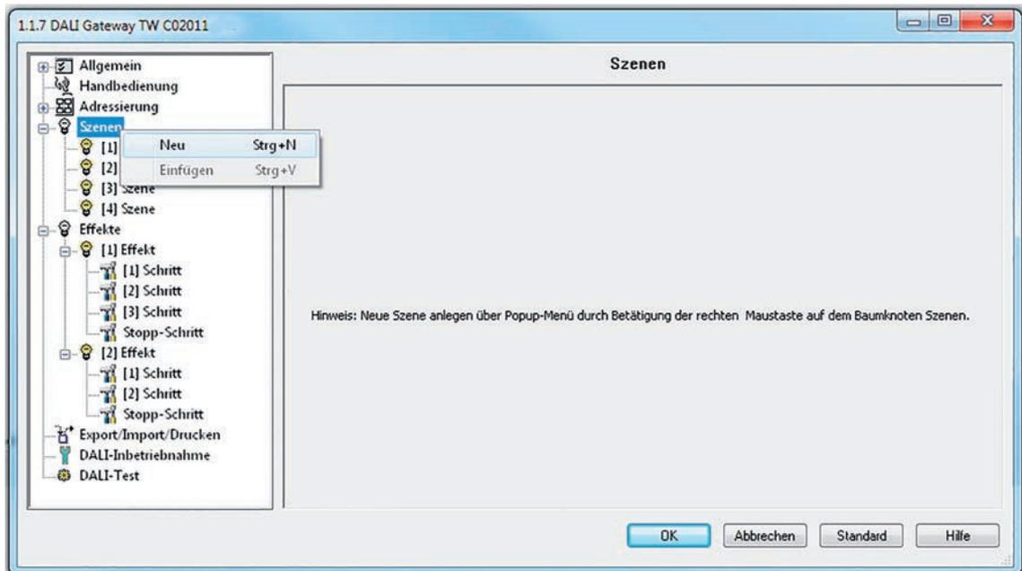
Bild 21: Hinzufügen von Szenen (Effekte und Effektschritte sinngemäß gleich)
