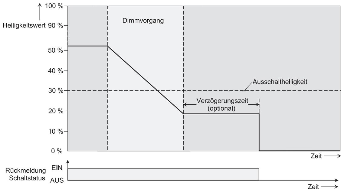
Bild 41: Dimm- und Schaltverhalten der automatischen Ausschaltfunktion
