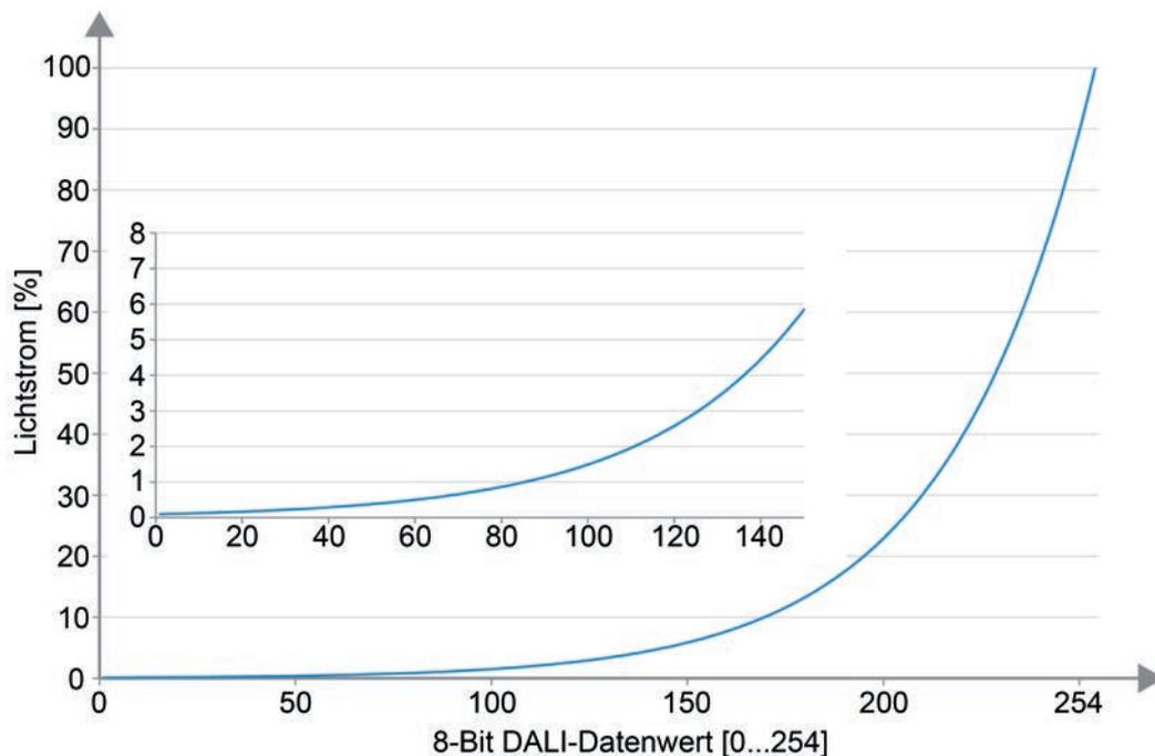
Bild 32: Logarithmische Dimmkurve in DALI-Betriebsgeräten
