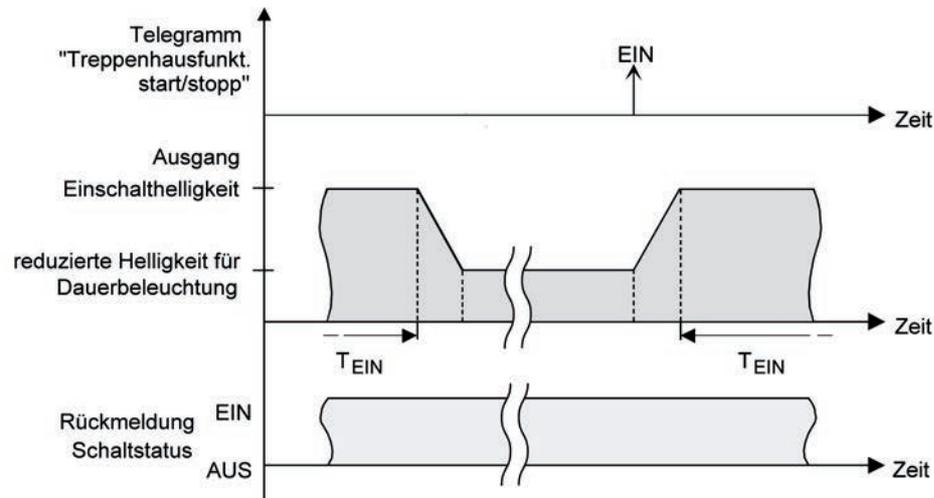
Bild 50: Die Dauerbeleuchtung der Treppenhausfunktion mit Soft-AUS-Funktion
