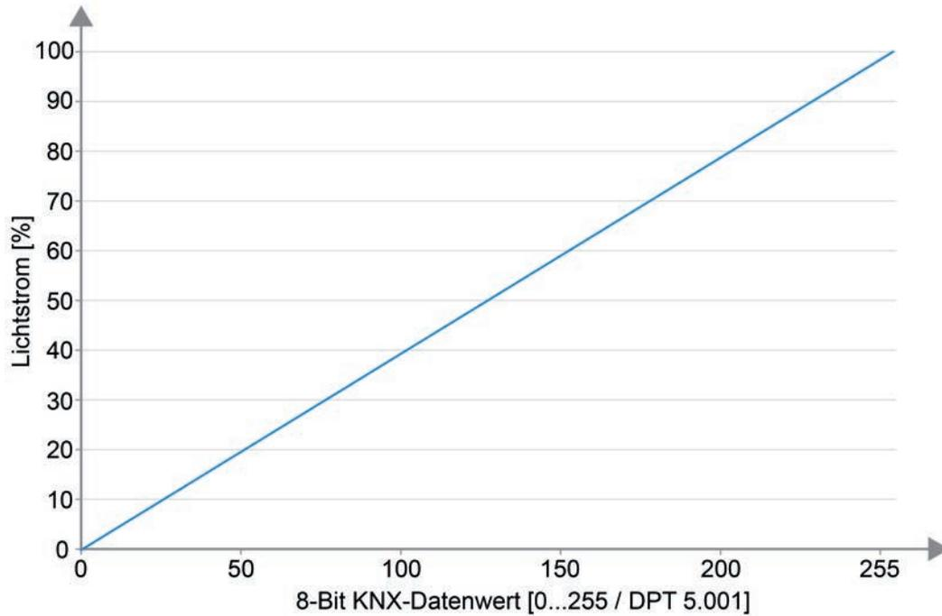
Bild 33: Lineare DALI-Dimmkennlinie
