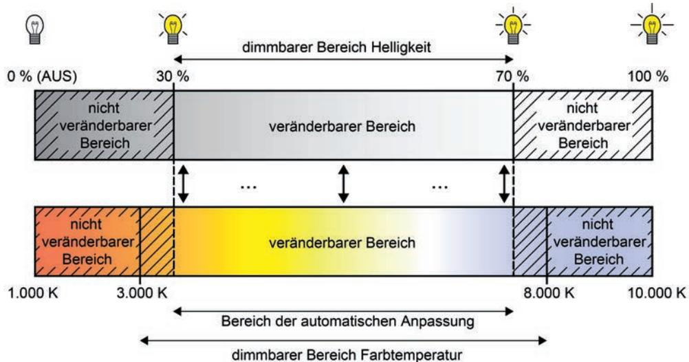
Bild 38: Automatische Anpassung der Farbtemperatur an die eingestellte Helligkeit
