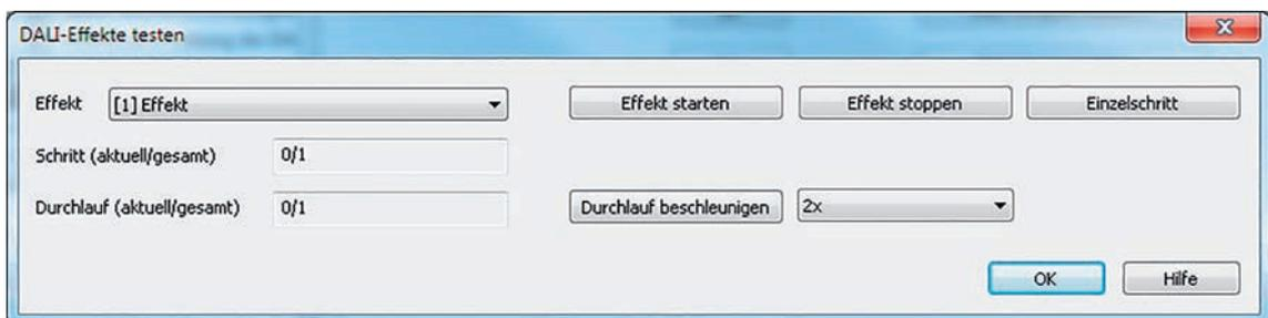
Bild 84: DALI-Testumgebung für Effekte
