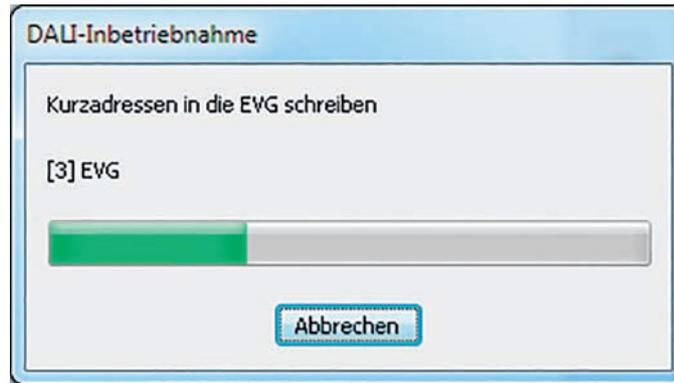
Bild 74: Abgleich der Inbetriebnahmeparameter zwischen Gateway und den DALI-Betriebsgeräten.
