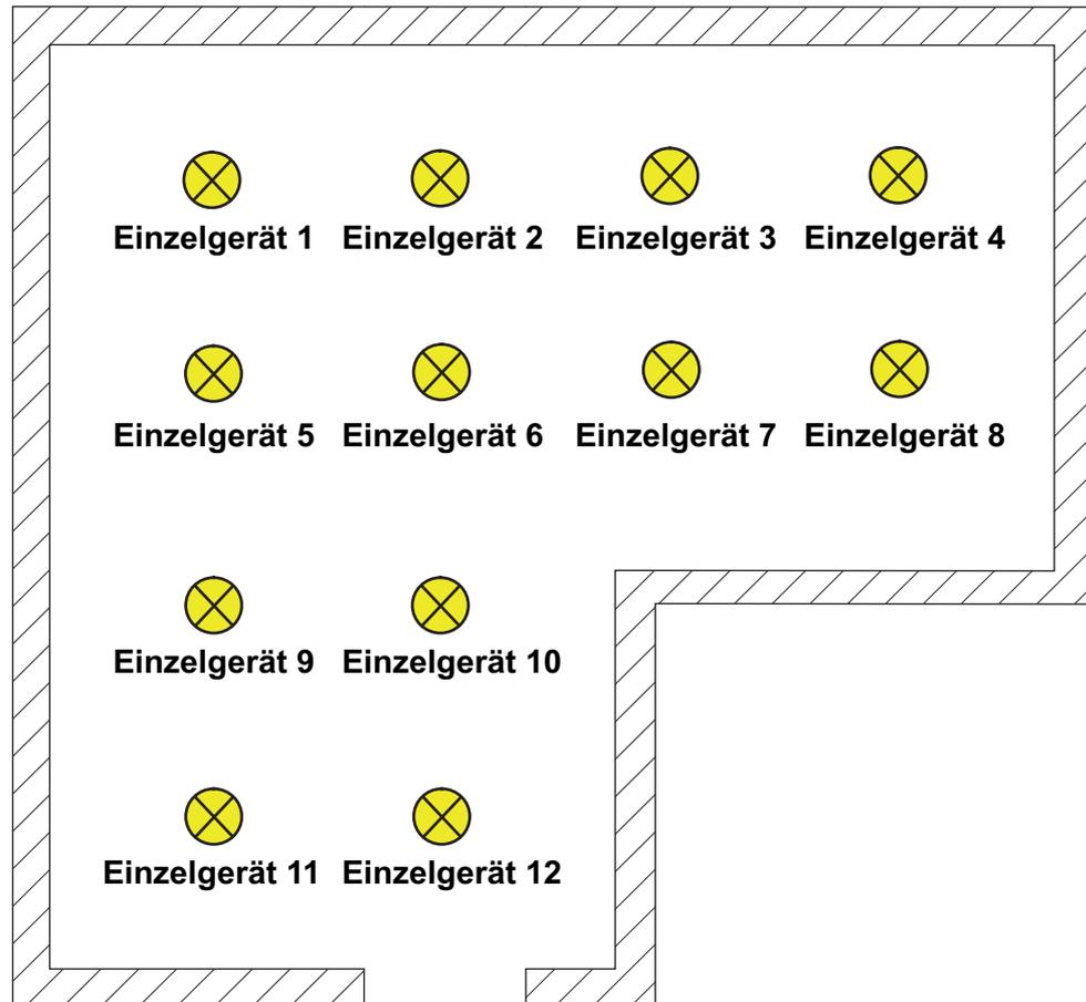
Bild 14: Beispiel einer Einzelgerätsteuerung - Alle DALI-Betriebsgeräte individuell ansteuerbar
