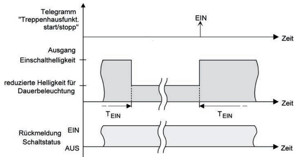
Bild 49: Die Dauerbeleuchtung der Treppenhausfunktion ohne Soft-Funktionen
