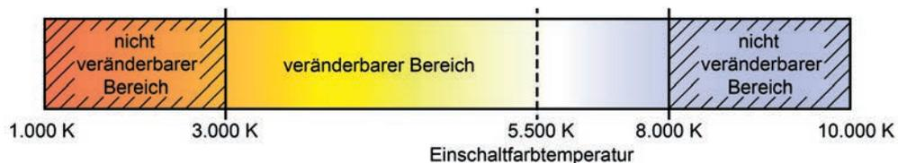
Bild 35: Beispiel eines konfigurierten Farbtemperaturbereichs mit Einschaltfarbtemperatur
