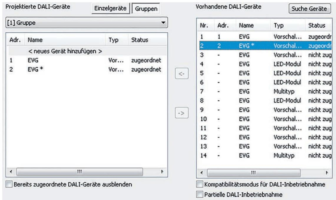
Bild 69: Betriebsgerät einer Gruppe zugeordnet
