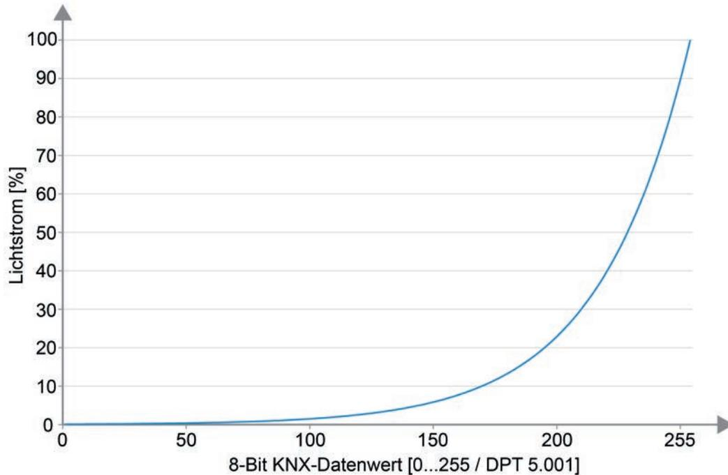
Bild 34: Logarithmische DALI-Dimmkennlinie
