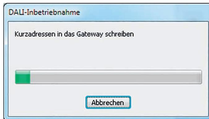
Bild 73: Abgleich der Inbetriebnahmeparameter zwischen Plug-In und DALI-Gateway.
