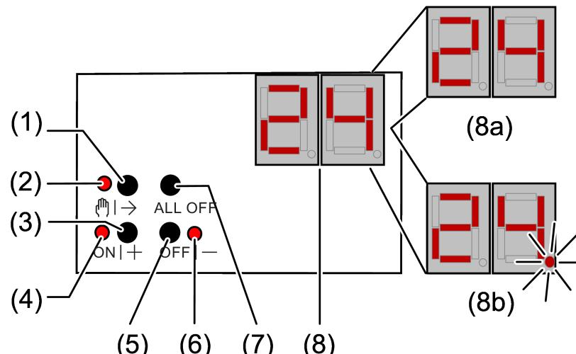
рисунок 1: Панель управления 1-канальным шлюзом DALI
