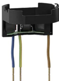
Das Gira Überspannungsschutz-Modul bewahrt Elektrogeräte vor transienten Überspannungen. Dafür wird das Ringmodul einfach hinten auf die Steckdose gesteckt. Durch die kompakte Bauform bietet das Modul genügend Verdrahtungsraum in der Unterputz-Gerätedose. Zusätzlich profitieren weitere Steckdosen vom Überspannungsschutz, wenn sie innerhalb einer Leitungslänge von bis zu 5 m liegen.
