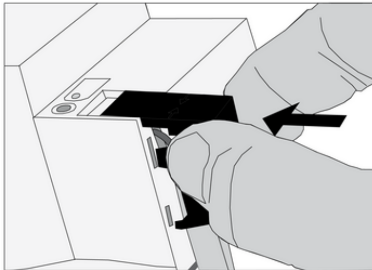
Figura 9: Applicazione della calotta di copertura
