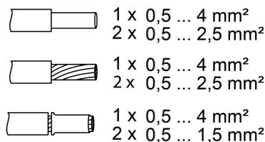
Imagen 4: Secciones de conductor enchufables
