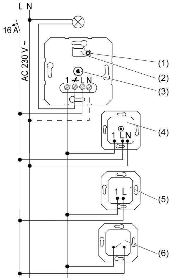
Imagen 3: Plan de conexión con mecanismos auxiliares opcionales
