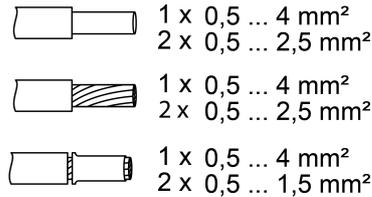
рисунок 4: Зажимаемое поперечное сечение провода
