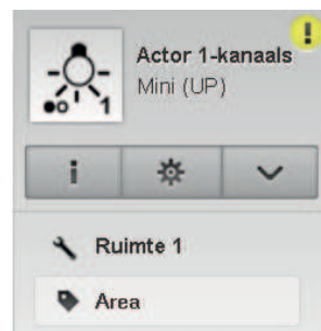
Afbeelding 8: Apparaat in het project komt niet overeen met het apparaat in de installatie
