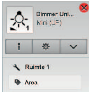
Afbeelding 9: Apparaat in de installatie is niet via het projecteringsscherm bereikbaar
