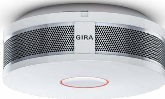
Mit dem Rauchwarnmelder Dual Q sind Sie gleich doppelt sicher. Er nutzt neben der Streulichtmessung zusätzlich auch einen Wärmesensor, um z. B. Flüssigkeitsbrände schneller erkennen zu können. Zusätzlich lässt er sich mit bis zu 40 anderen Geräten vernetzen, in eine KNX oder Funk-Installation einbinden und sogar zur Anbindung externer Alarmgeber, wie einer Rüttelkiste für hörgeschädigte Menschen, nutzen.
