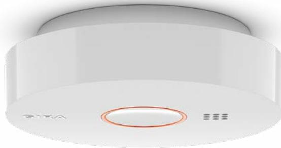
Der Rauchwarnmelder Basic Q erkennt über die Streulichtmessung, wenn es zu gefährlicher Rauchentwicklung kommt, und schlägt über einen lauten, pulsierenden Alarmton sowie einen roten LED-Leuchtring Alarm. Er besitzt eine fest integrierte Batterie, die mindestens 10 Jahre bis zum vorgeschriebenen Wechsel läuft und fügt sich dank des dezenten Designs beinahe unsichtbar in jeden Raum ein.
