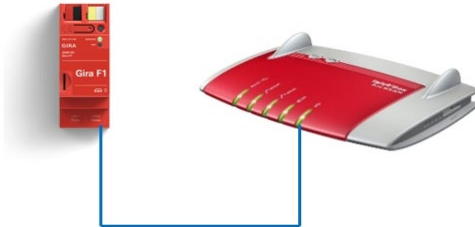
Diese Anleitung zeigt Ihnen, wie Sie eine Fritz!Box im Zusammenspiel mit dem Gira F1 verwenden können und eingehende Türrufe einer IP Türstation an angeschlossenen Telefonen signalisiert werden.
