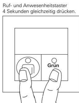
Bild 5.1: Beide Tasten 4 Sekunden gleichzeitig drücken.
